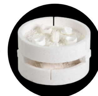
6 Sinterización apilada de restauraciones.
